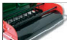
Der Saatigel wird durch betätigen des Bügels in Arbeitsstellung oder Transportstellung gebracht.
